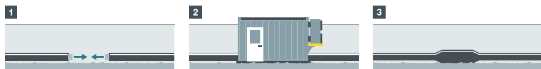
Abbildung 4: Schematische Darstellung der Kabelverbindungen (Muffen) 4
